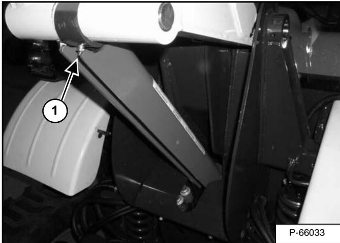
1. Rod End Lift Cylinder (1) [Figure PM-57].
